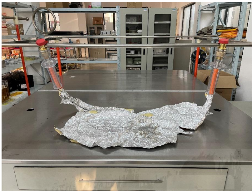
图2 引流线的交流耐压试验
