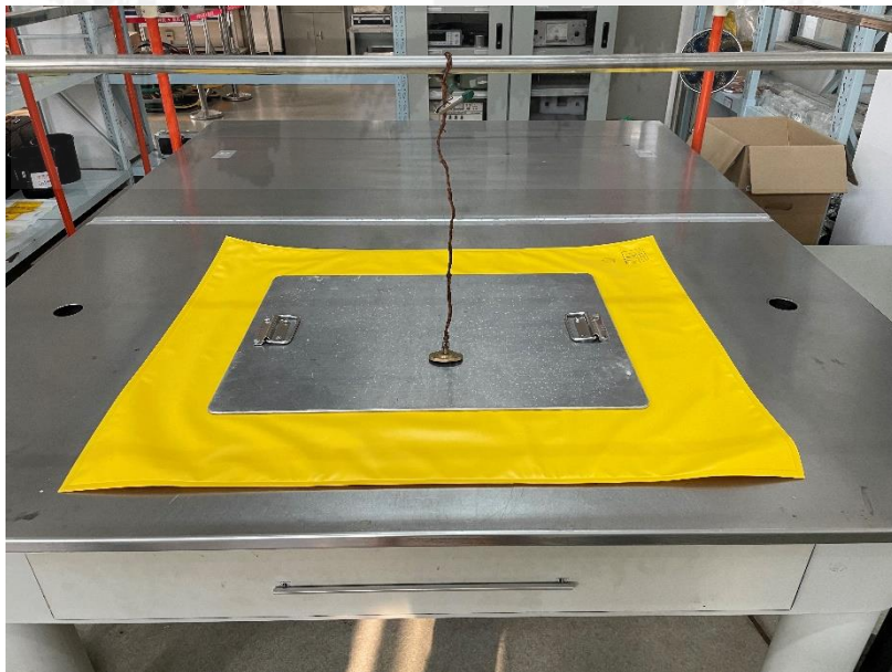
图 1 绝缘毯的交流耐压试验
